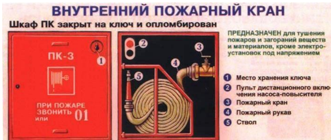
Рисунок 3 – Внутренний пожарный кран
