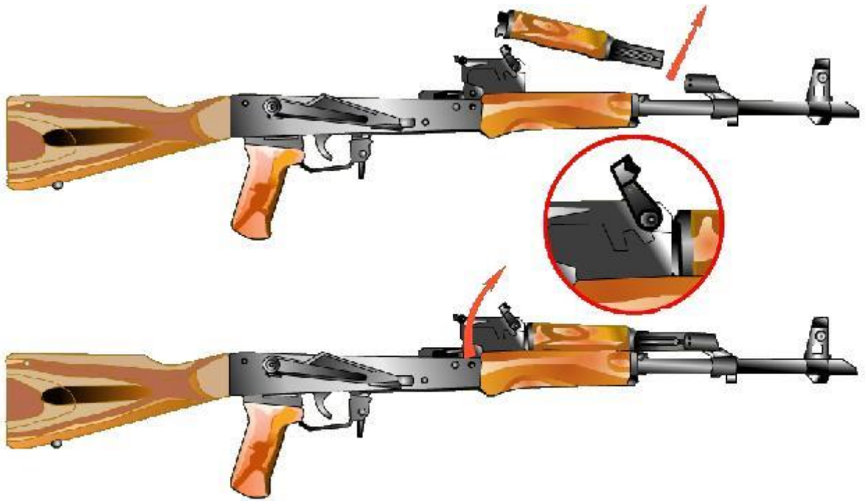
Рис. 9. Отделение газовой трубки со ствольной накладкой
